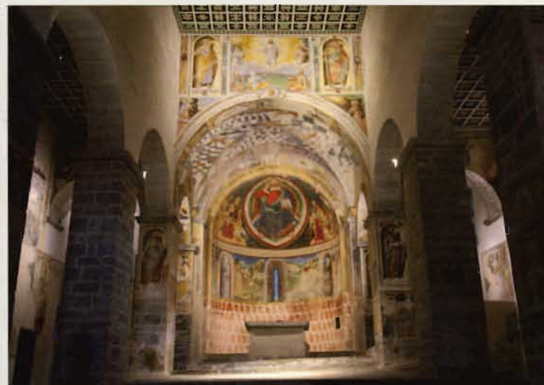
A sinistr: gli interni del Santuario della Madonna del Sasso a Locarno. L'illuminazione a Led è stata posta sulle catene e la soluzione adottata ha distribuito uniformemente la luce utilizzando sfere con rotazioni multiple
